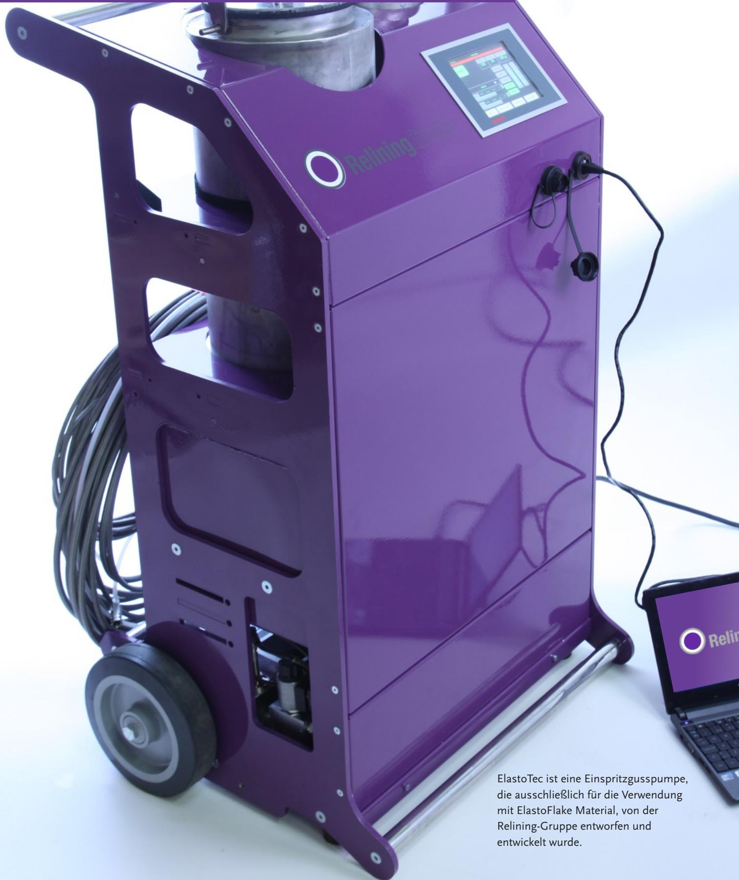
ElastoTec ist eine Einspritzgusspumpe, die ausschließlich für die Verwendung mit ElastoFlake Material, von der Relining-Gruppe entworfen und entwickelt wurde.
